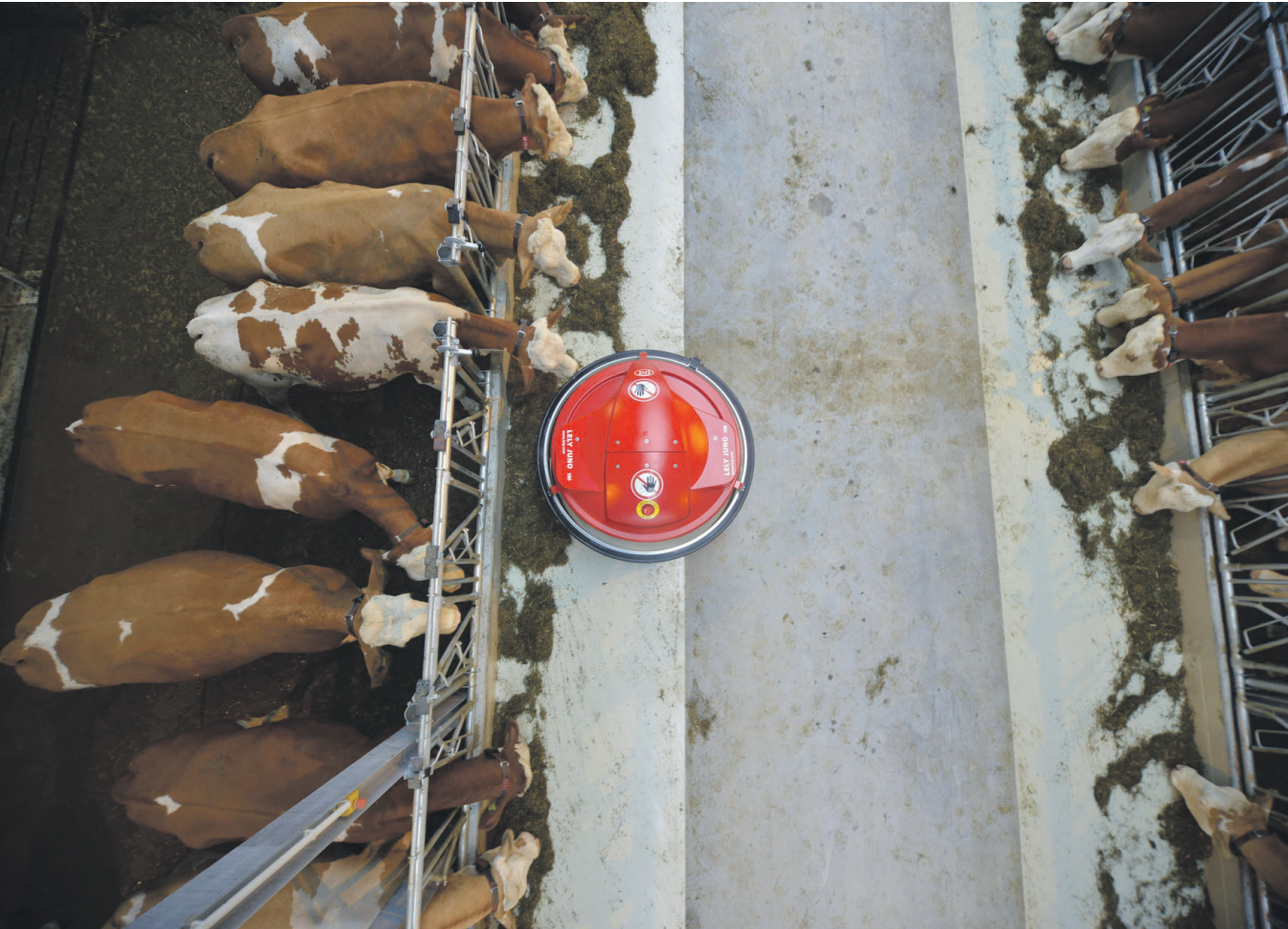
Automatische voerrobot op een melkveebedrijf in Nederland. Lely International.
